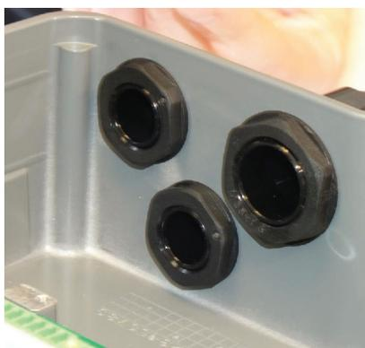
L'antenne doit être installée à l'extérieur de l'onduleur à la place de l'un des presses-étoupes de service (taille M20).
