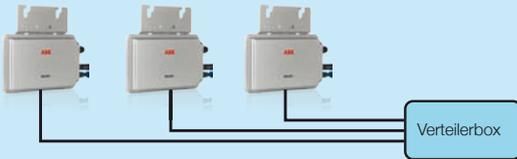
Kleine Anlagen, mehr als vier MICRO Wechselrichter
