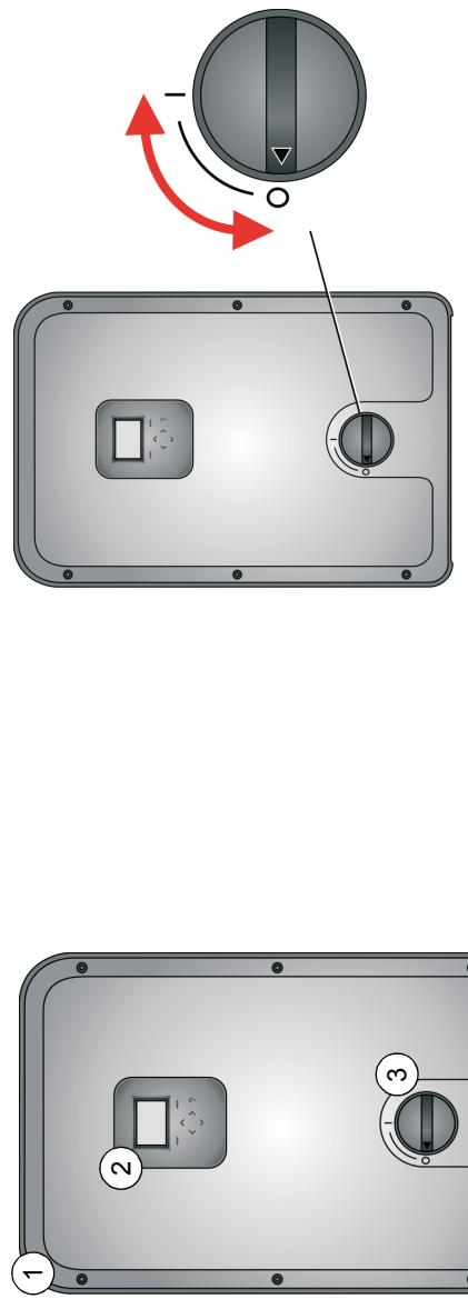
Den Wechselrichter mit dem DC-Schalter auf der Frontabdeckung ein- und ausschalten. Der Wechselrichter sollte immer eingeschaltet bleiben, außer bei der Wartung oder einer Störung.
