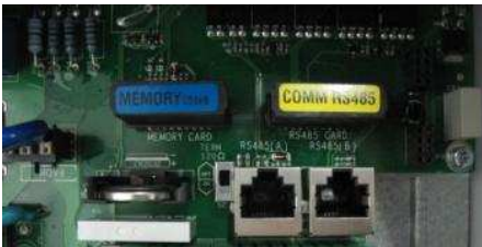
Abb. 15 – Austausch der Lithium-Batterie
