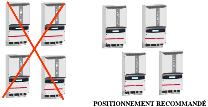
Fig. 5 - Installation recommandée des onduleurs AURORA
