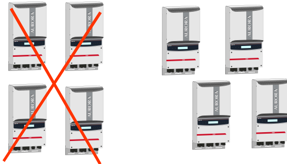
Abb. 5 - Empfohlene Installation der Aurora-Wechselrichter
