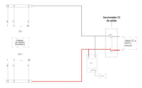
Fig. 1. Schema a blocchi della cassetta di campo.
