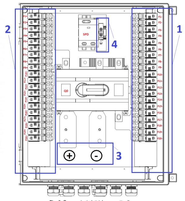
Fig. 6. Connessioni elettriche cassetta di campo
