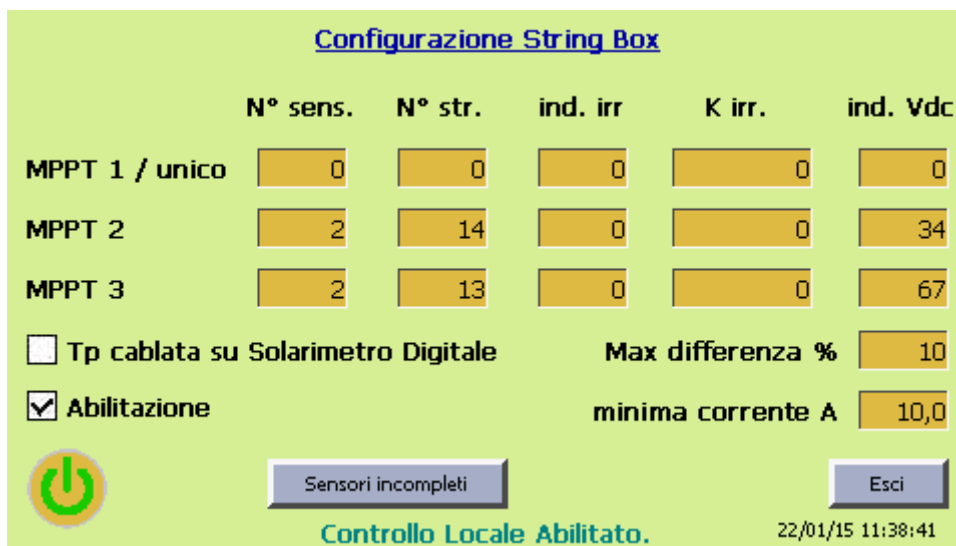
Fig. 20. Esempio di schermata “Configurazione String Box”.
