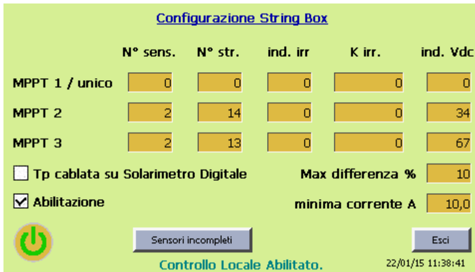
Fig. 20. Esempio di schermata “Configurazione String Box”.
